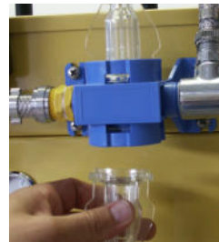
6. Adapterschauglas wieder am Ventil befestigen
