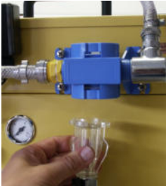
1. Adapterschauglas vom Ventil lösen
